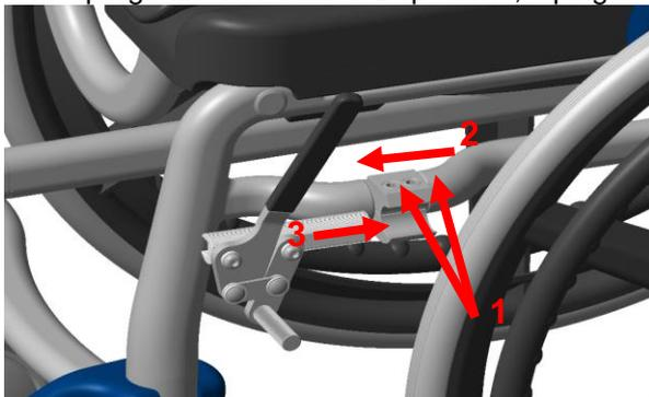
supporto del freno fino alla battuta (2) e serrare leggermente le due viti. Spingere la leva dei freni (3) attraverso l'apertura del supporto del freno e raddrizzarla.
